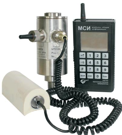
Примечание. Съемный датчик температуры установлен в накладной магнитный термокарман.
