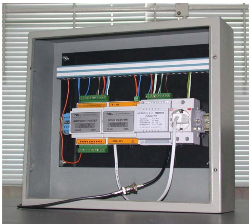
Рисунок 8. Контроллер телемеханики скважины КТС.1 (НПО «Интротест», Екатеринбург)
