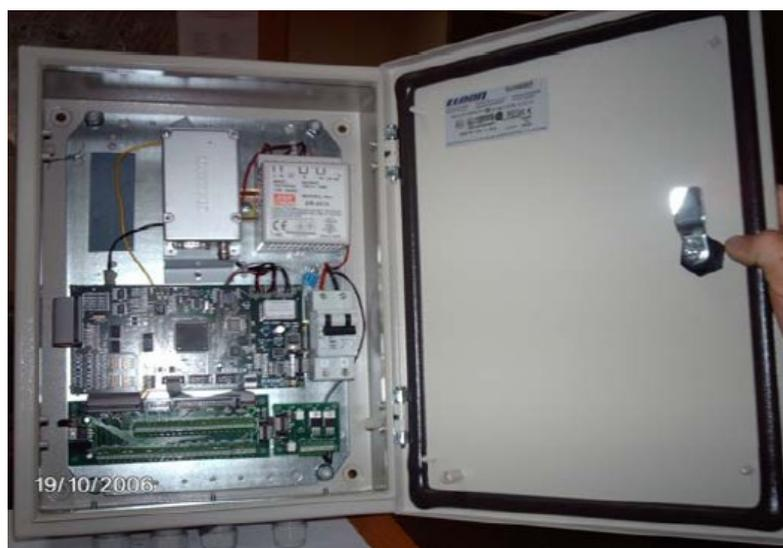
Рисунок 3 - Контроллер «Орион-НТ» (ООО «АЯКС лаб», Ульяновск)
