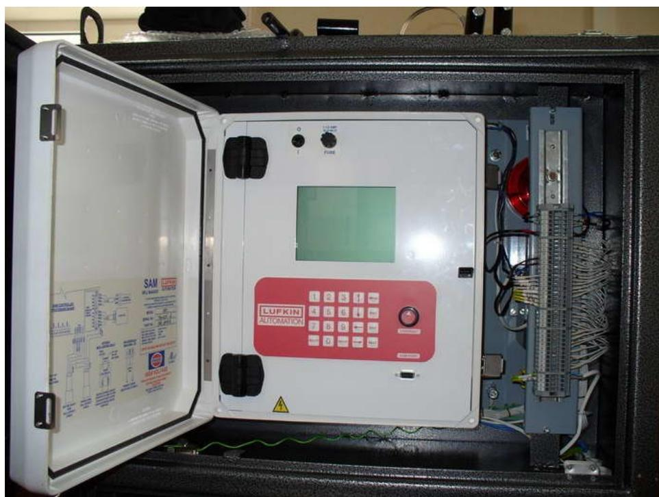
Рисунок 6 - Контроллер SAM Well Manager фирмы Lufkin
