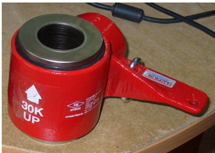
Рисунок 4 – Датчик усилия Loadrol (США)
